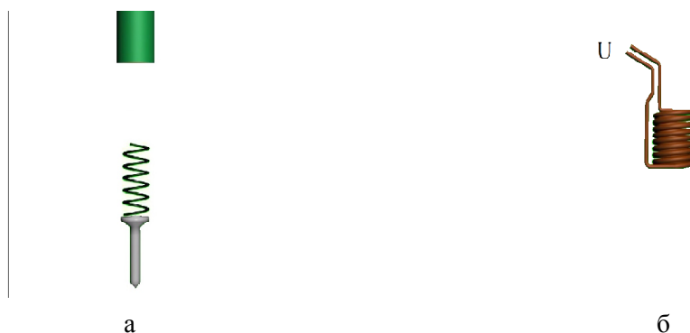
Рис. 2. Вспомогательные листы: а) изображение запорной иглы с пружиной, трубопроводом; б) изображение электромагнитной катушки.
